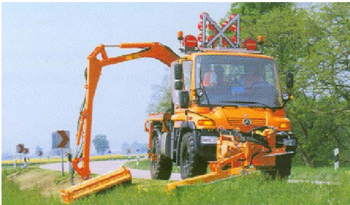
**Košenje bankine sa bočnom kosilicom**
