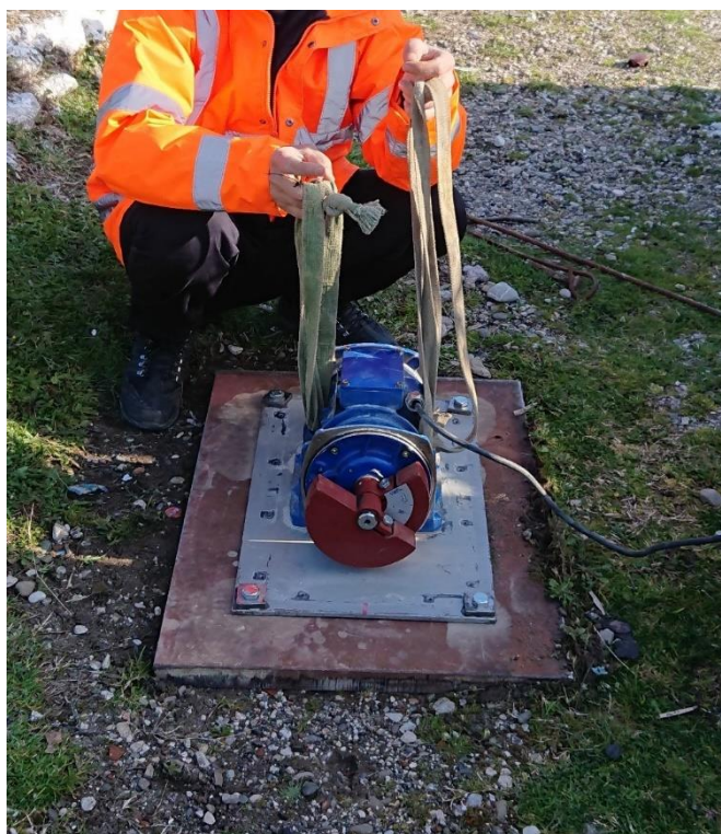
Slika 12-3: 250 kg generator vibracija
