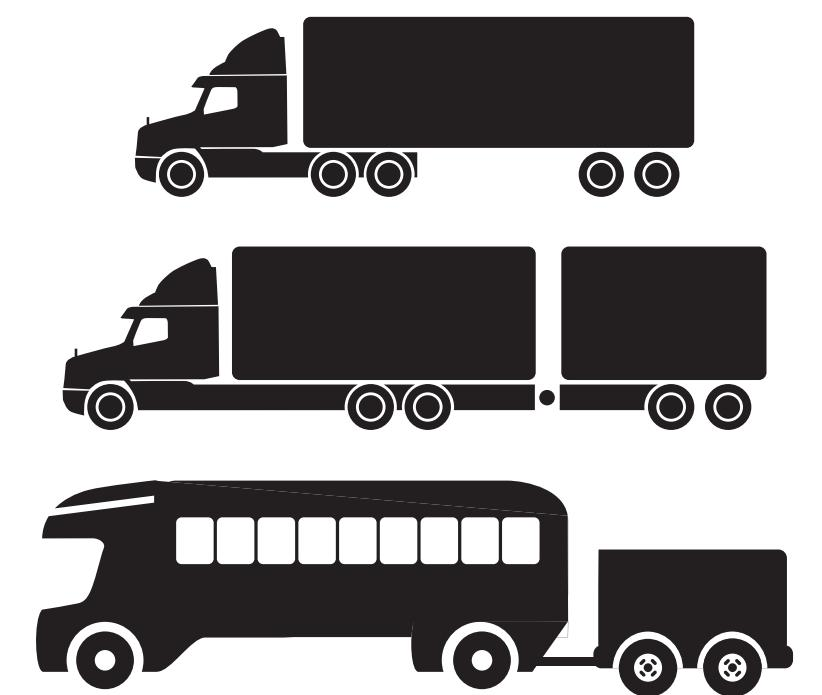
Vozila sa četiri ili više osovine i visinom mjerena na prvoj osovinu većom od 1,3 m (kamioni sa ili bez prikolice sa četiri ili više osovine, tegljači sa poluprikolicom, autobusi sa ili bez prikolice sa četiri ili više osovine, kombi vozila sa prikolicom ili karavanom sa ukupno četiri ili više osovine, vozila najveće dozvoljene mase preko 3.500 kg, vozila registrirana preko 9 sjedišta).
