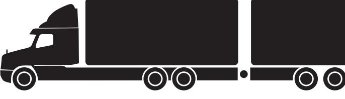
Vozila sa četiri ili više osovine i visinom mjerena na prvoj osovinu većom od 1,3 m (kamioni sa ili bez prikolice sa četiri ili više osovine, tegljači sa poluprikolicom, autobusi sa ili bez prikolice sa četiri ili više osovine, kombi vozila sa prikolicom ili karavanom sa ukupno četiri ili više osovine, vozila najveće dozvoljene mase preko 3.500 kg, vozila registrirana preko 9 sjedišta).
