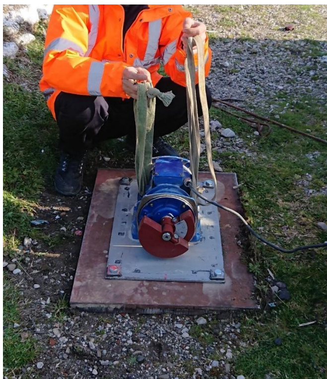
Slika 12-3: 250 kg generator vibracija
