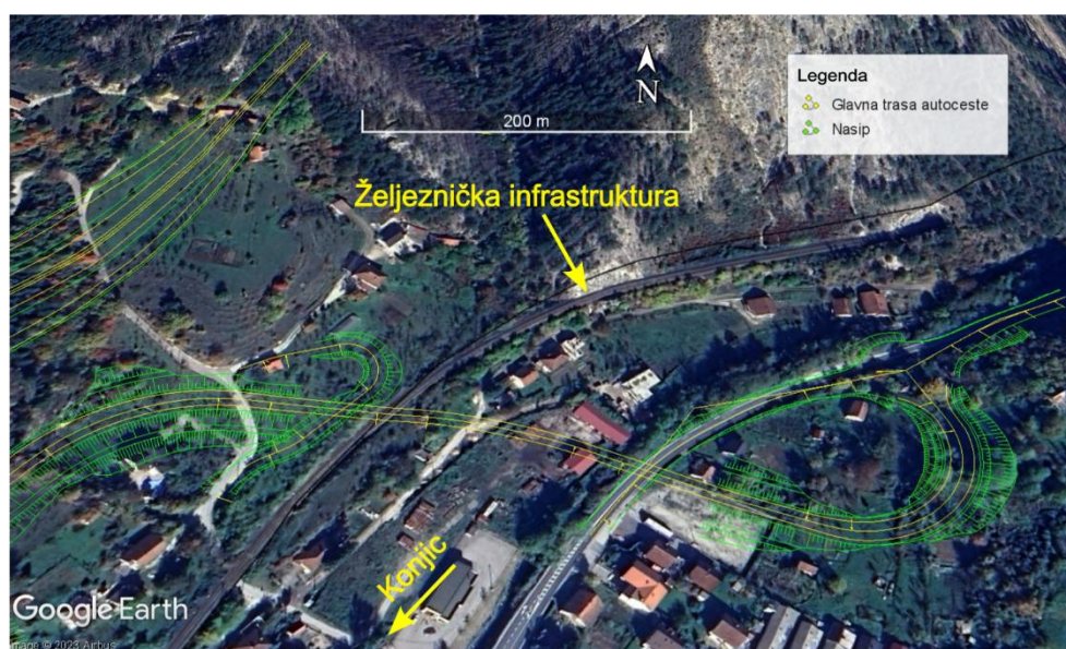
Slika 16-9: Željeznička infrastruktura presječena vijaduktom između petlje Ovčari i prilaznog puta autoceste
